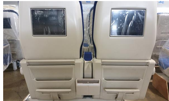
특실 방송장치(VOD) 설치
